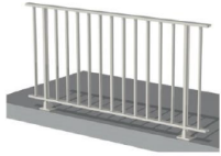
Barreaudage sous main courante
