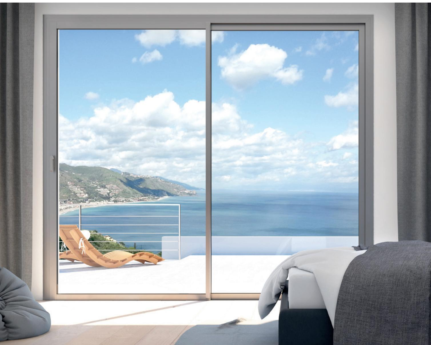
Le coulissant Schüco ASS 41 SC se distingue par ses masses vues Aluminium réduites (17%) qui augmentent la surface vitrée (83%), favorisant ainsi les apports solaires et la transmission lumineuse. La finesse des profilés Aluminium à rupture de pont thermique, associée aux grandes surfaces de vitrage, assure une isolation thermique exceptionnelle (jusqu'à  $U_w = 1.4 \text{ W/m}^2\cdot\text{K}$ ).
